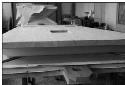
Výroba měchů z vybraného smrkového dřeva z Jeseníků
